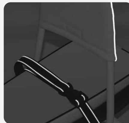
Ремень безопасности со светоотражающей полосой и кант на спинке позволяют заметить снегокат в тёмное время суток
