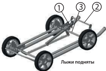
Рис. 3 Механизм выдвигаемых лыж
